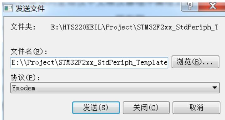
6、之后显示发送程序的进程，都更新完成后，按【3】键结束升级，直接运行仪器程序，之后关闭超级终端。
